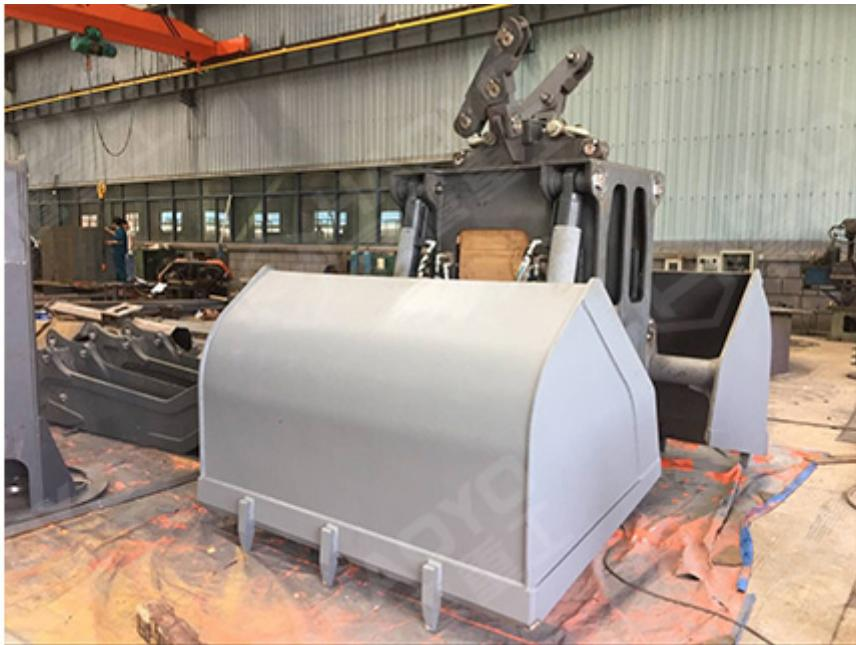
抓斗是起重机不可缺少的重要部件，抓斗的质量决定了起重机能夾取到所需的重物。质量抓斗使用寿命长，使用方便，不易破碎。但是，同一个抓斗不能满足起重机的所有要求，抓斗的选择应严格控制。选择合适的抓斗工作是起重工作的重要环节。那么如何选择合适的抓取呢？首先，根据起重机选择抓斗的动力形式。根据抓斗的定义，抓斗是起重机下的抓取装置，所以即使是比较先进的抓斗也可以在没有起重机的情况下单独工作。相反，即使是比较先进的大吨位卸船机也离不开抓斗，具有生产效率。其次，根据要装卸的货物类型，选择抓斗结构。根据抓斗的定义，抓斗用于装卸各种货物。所以装卸什么样的货物，都要配相应的抓斗。双瓣抓斗价格哪家便宜？欢迎来电上海豪鹰机械设备有限公司。北京专业双瓣抓斗维修
